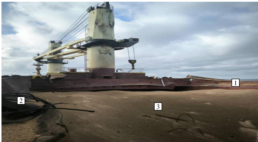
Рисунок 2. Вид трюму № 3 з повністю відірваними кришками, з зерном у стані фумігації фосфіном (1- повністю зруйнований комінгс, 2- фрагмент відірваної кришки, 3-видкрита поверхня горілого від вибуху зерна, з якого постійно виходить отруйний газ фосфін, вибухові та пожежні гази)
