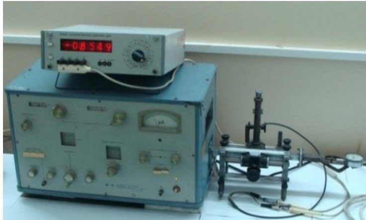
Рис. 1. Общий вид измерительного комплекса на базе волноводной измерительной линии (ИЛ) с зондом и передвижным плунжером с микрометрическим винтом
